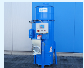
PF-2B MIT STEUERUNG UND PNEUMATIKSCHIEBER
