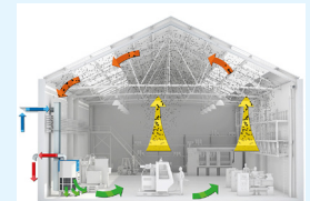
HALLENLÜFTUNG IM UMLUFTBETRIEB
