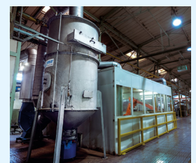
LA-VX IN FEUERVERZINKTER AUSFÜHRUNG
