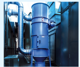
ZF-1 MIT SCHALLDÄMMHAUBE
